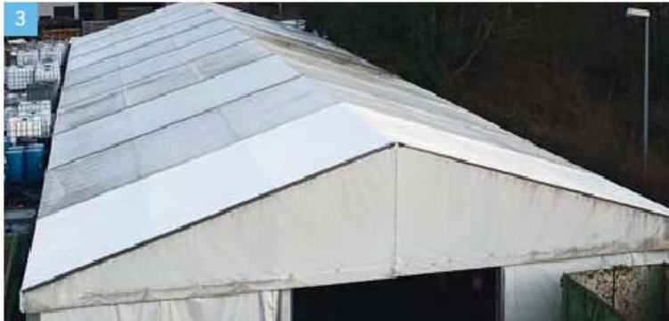
3 Feld aus nano TiO 2 nach 9 Monaten. UK Feld aus nano TiO 2 nach 9 Monaten. Entwicklungs-Musterstand: Vergleich nach 12 Monaten
